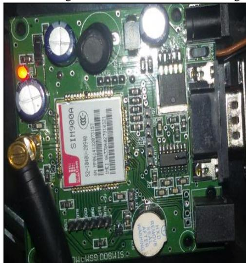
Fig. 3: GSM Module
