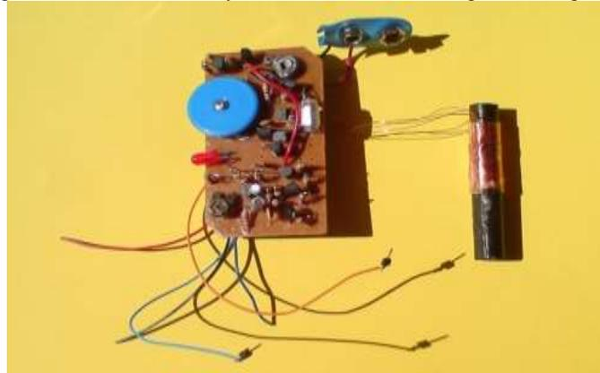
Fig. 3: Metal Detector Sensor
