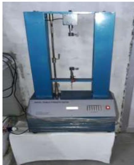
Fig. 8: Tensile Machine
