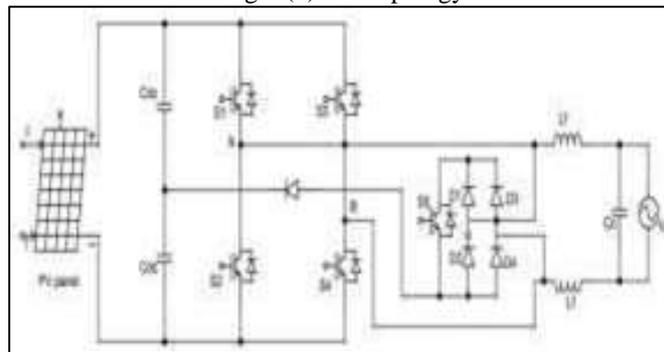
Fig. 4(e): HB-ZVR inverter topologies
